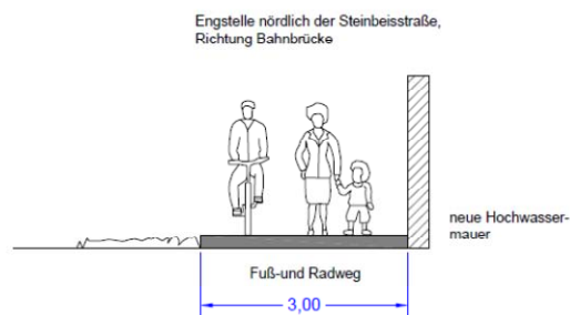
Abbildung 6-19: Querschnitt zwischen Steinbeisstraße und Eisenbahnbrücke
